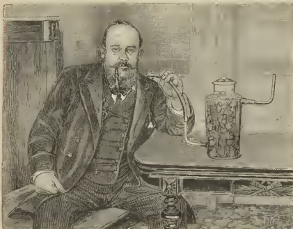
Fig. 1. - Destrucción del humo. Aparato de demostración
